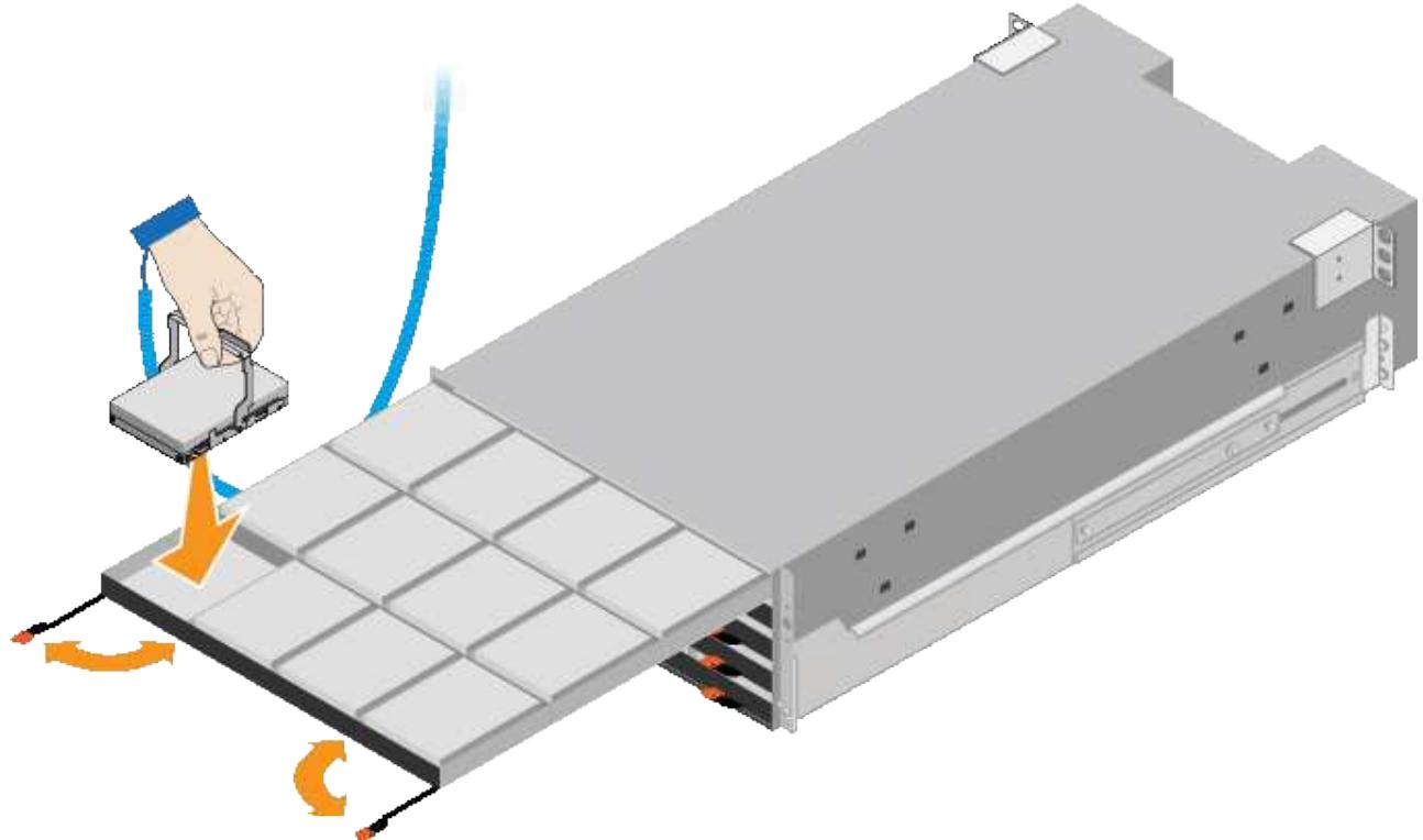
e. 12本のNL-SAS ドライブを上段のドロワーに取り付けます。
