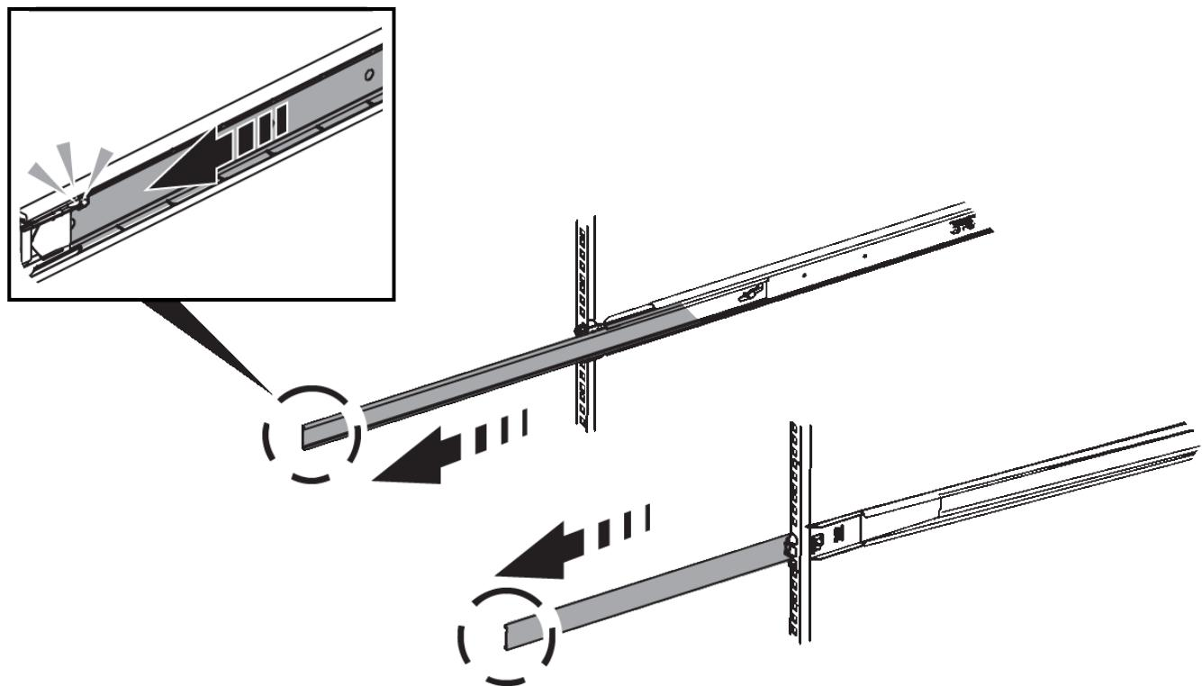
3. SG6100-CNコントローラをレールに挿入します。
