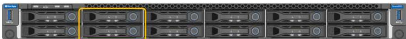
オレンジの枠で示される2本のソリッドステートドライブ（SSD）は、StorageGRID オペレーティングシステムの格納に使用され、冗長性を確保するために RAID 1 を使用してミラーリングされます。SG100 または SG1000 サービスアプライアンスが管理ノードとして設定されている場合は、それらのドライブを使用して監査ログ、指標、およびデータベーステーブルを格納できます。
