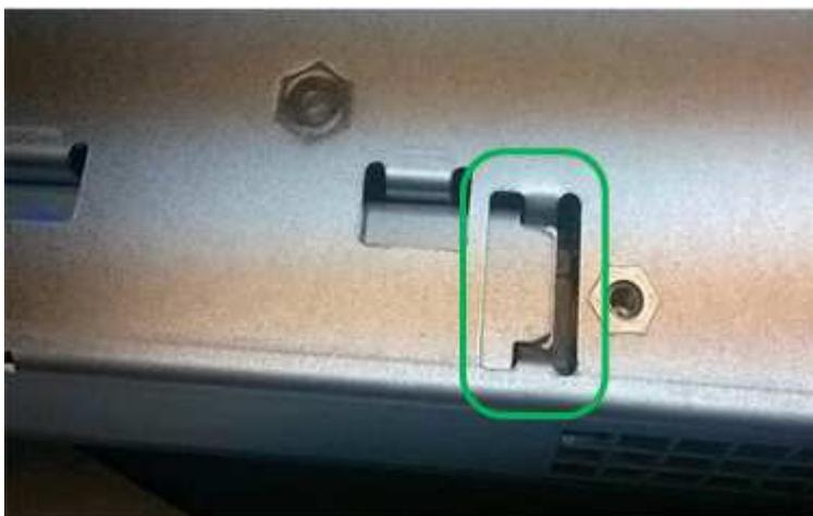
◦ \* 不正解—バッテリーの金属製のフランジがコントローラのスロットに挿入されていません \*
