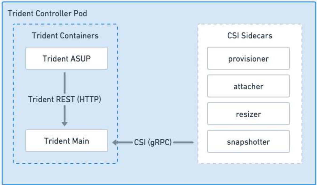
図 2. Tridentコントローラポッドの図
