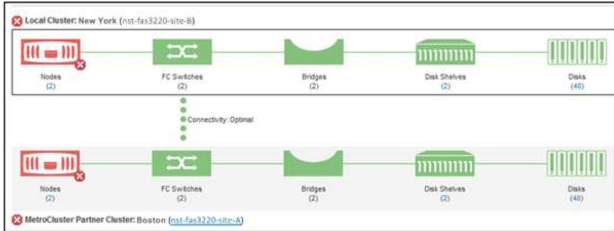
MetroCluster 구성의 토플로지가 해당 클러스터 오브젝트 영역에 표시됩니다. 클러스터/상태 세부 정보 페이지에 표시된 정보를 사용하여 연결 문제를 해결할 수 있습니다. 예를 들어, 노드와 클러스터 내 스위치 간의 연결이 다운된 경우 다음 아이콘이 표시됩니다.
