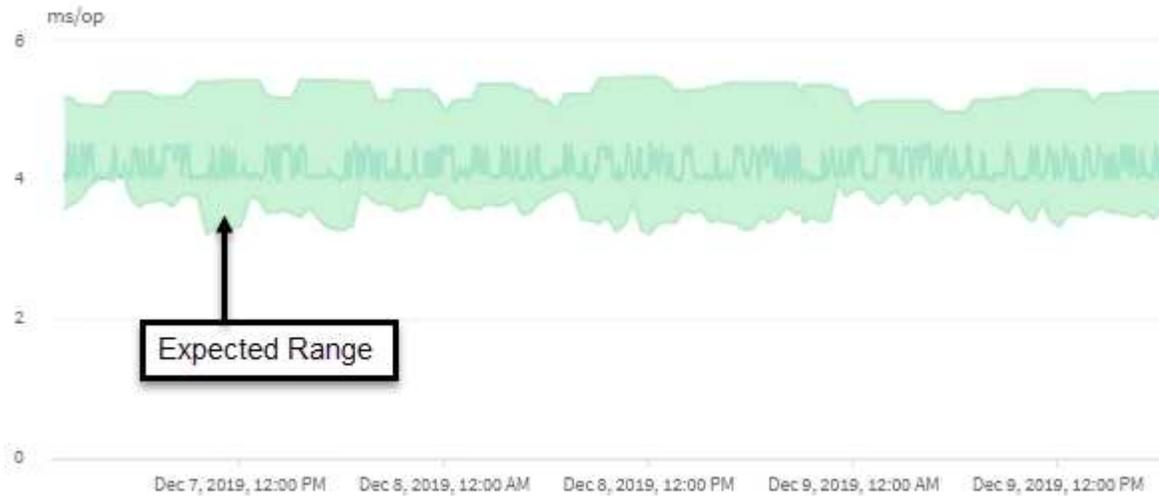
이 예에서 볼륨의 지연 시간은 지연 시간 예측(회색으로, 작업당 3.5밀리초(ms/op)이 가장 낮고 5.5ms/op이 가장 높은 것으로 표시됩니다. 네트워크 트래픽이 간헐적으로 급증하거나 클러스터 구성 요소의 경합으로 인해 실제 지연 시간이 갑자기 10ms/op로 증가하는 경우, 지연 시간이 예상을 초과하고 동적 성능 임계값을 초과하게 됩니다.
