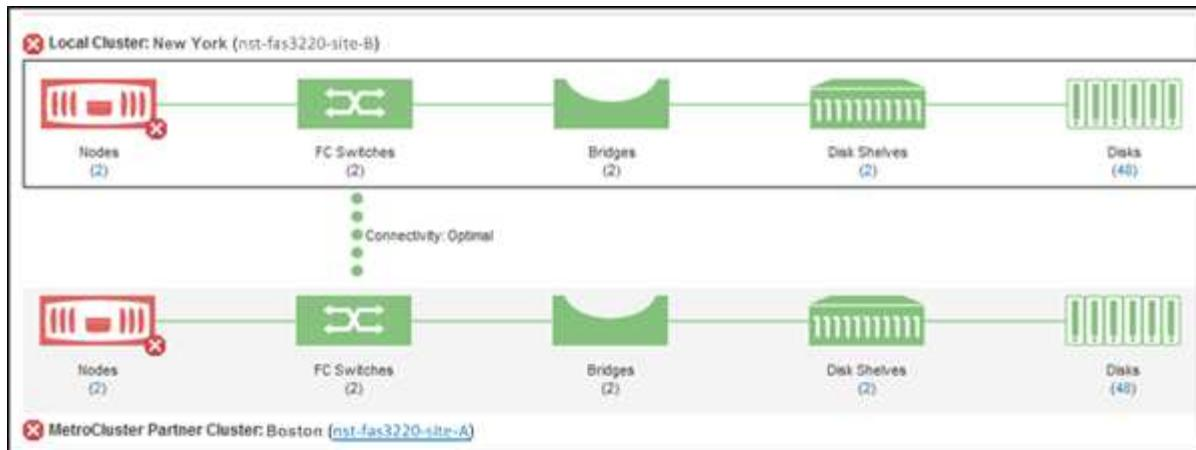
이 예에서는 로컬 클러스터와 파트너 클러스터의 이름과 구성 요소가 표시됩니다. 노란색 또는 빨간색 아이콘은 강조 표시된 구성 요소에 대한 상태 이벤트를 나타냅니다. 연결 아이콘은 클러스터 간의 링크를 나타냅니다. 마우스 커서를 아이콘에 갖다 대면 이벤트 정보를 표시하거나 아이콘을 클릭하여 이벤트를 표시할 수 있습니다. 두 클러스터의 상태 문제가 성능 이벤트에 영향을 줄 수 있습니다.
