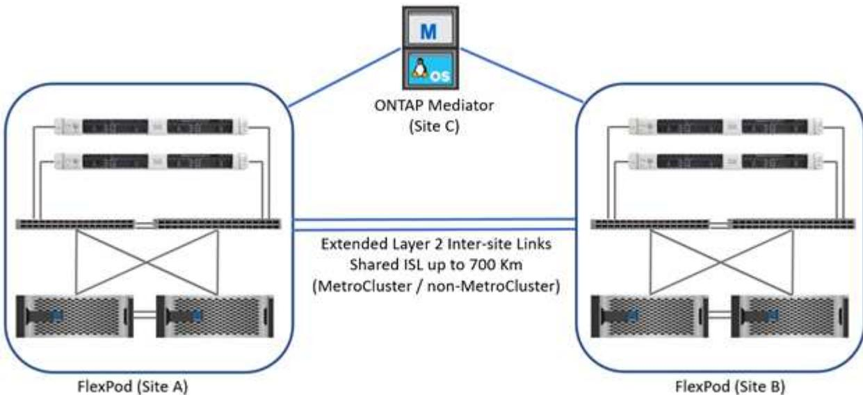
다음 두 그림에서는 VXLAN 멀티 사이트 패브릭 구축을 지원하는 FlexPod MetroCluster IP 솔루션을 위한 VXLAN 멀티 사이트 패브릭 및 MetroCluster IP 스토리지 패브릭을 보여 줍니다.
