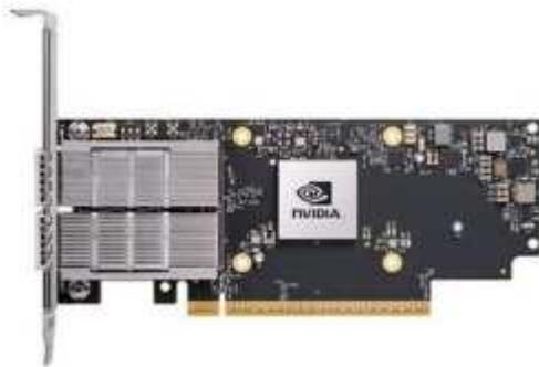
NVIDIA ConnectX-7 어댑터는 25/50/100/200/400G의 처리량을 제공할 수 있습니다. NVIDIA DGX 시스템은 단일 및 이중 포트 ConnectX-7 어댑터를 모두 사용하여 400Gb/s InfiniBand 및 이더넷을 통한 DGX BasePOD 배포에 유연성을 제공합니다.
