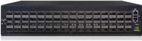
NVIDIA 스펙트럼 및 #8482; -3 SN4600 스위치는 총 128개의 포트(스위치당 64개)를 제공하여 DGX BasePOD의 대역 내 관리를 위한 이중화 연결을 제공합니다. NVIDIA SN4600 스위치는 1GbE 및 200GbE 사이의 속도를 제공할 수 있습니다. 이더넷을 통해 연결된 스토리지 어플라이언스의 경우 NVIDIA SN4600 스위치도 사용됩니다. NVIDIA DGX 이중 포트 ConnectX-7 어댑터의 포트는 대역 내 관리 및 스토리지 연결에 모두 사용됩니다.
