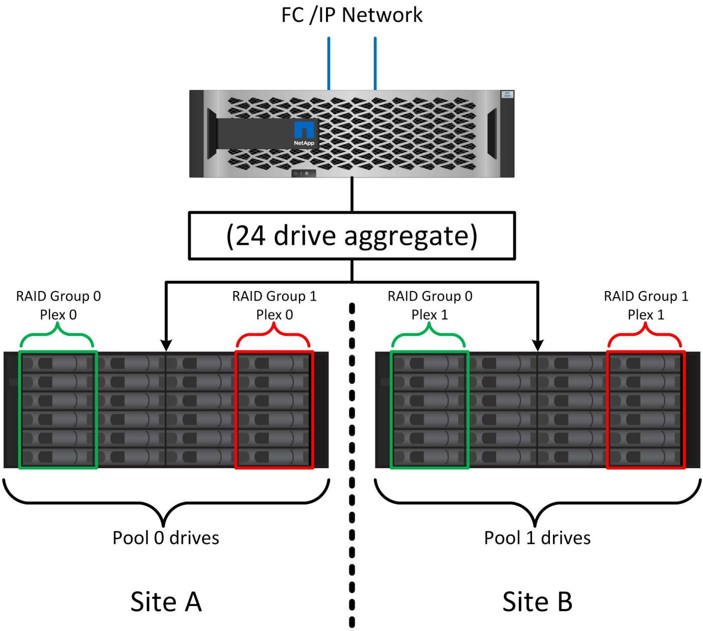
위 그림은 SyncMirror 구성의 예를 보여 줍니다. 24-드라이브 애그리게이트가 사이트 A에 할당된 쉘프의 드라이브 12개와 사이트 B에 할당된 쉘프의 드라이브 12개로 컨트롤러에서 생성되었습니다. 드라이브는 두 개의 미러링된 RAID 그룹으로 그룹화되었습니다. RAID 그룹 0에는 사이트 A의 6개 드라이브 플렉스가 사이트 B의 6개 드라이브 플렉스에 미러링됩니다. 마찬가지로, RAID 그룹 1에는 사이트 A의 6개 드라이브 플렉스가 사이트 B의 6개 드라이브 플렉스에 미러링됩니다.
