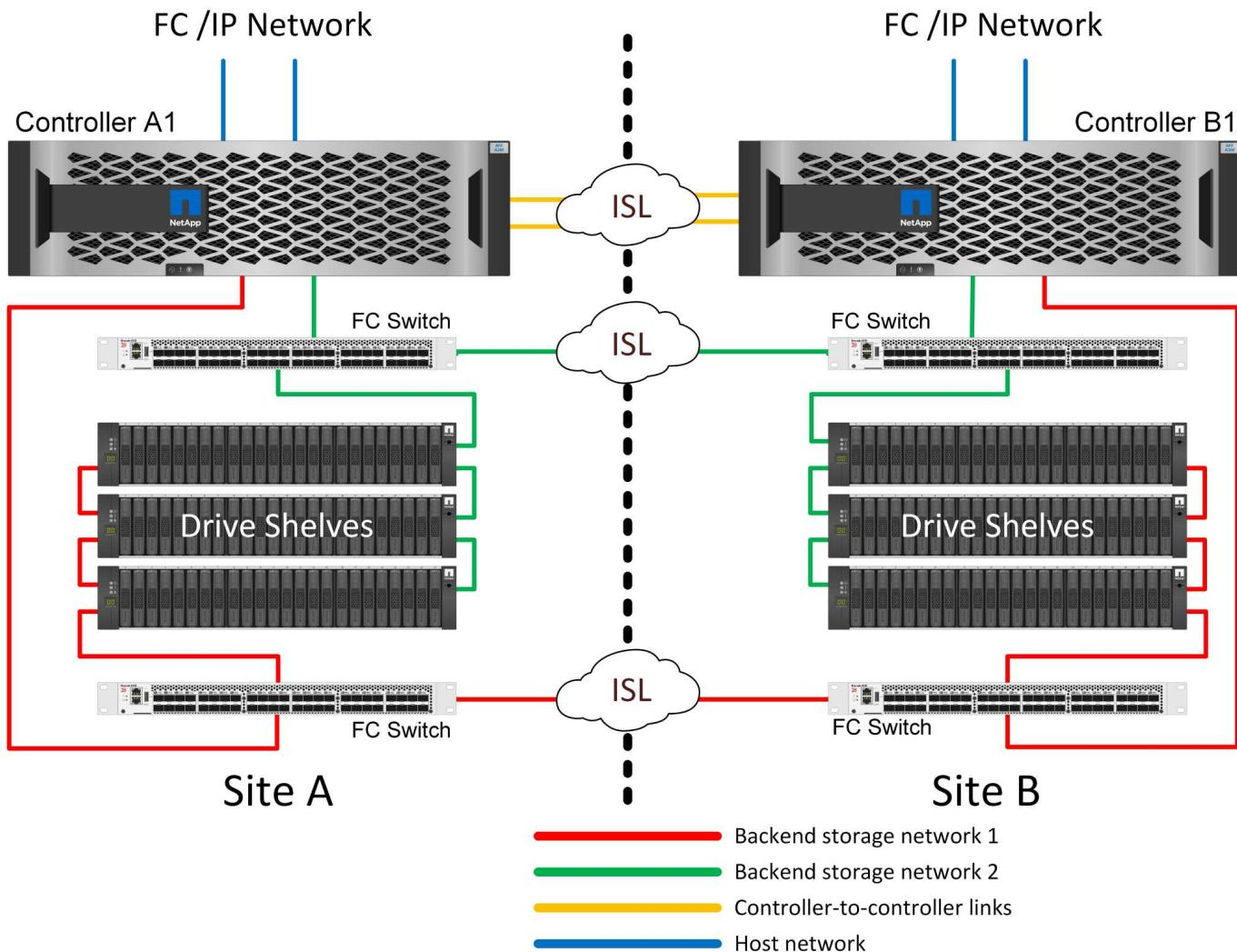
이 설계의 분명한 영향은 단일 사이트에서 컨트롤러 장애가 발생하면 반대쪽 사이트에서 데이터를 사용할 수 있다는 것입니다. 이러한 제한이 반드시 문제가 되는 것은 아닙니다. 많은 기업은 기본적으로 단일 인프라로 작동하는 지연 시간이 짧은 확장된 고속 네트워크를 통해 멀티사이트 데이터 센터를 운영하고 있습니다. 이 경우 MetroCluster의 2노드 버전을 사용하는 것이 좋습니다. 현재 여러 서비스 공급자가 두 노드 시스템을 페타바이트 규모로 사용하고 있습니다.
