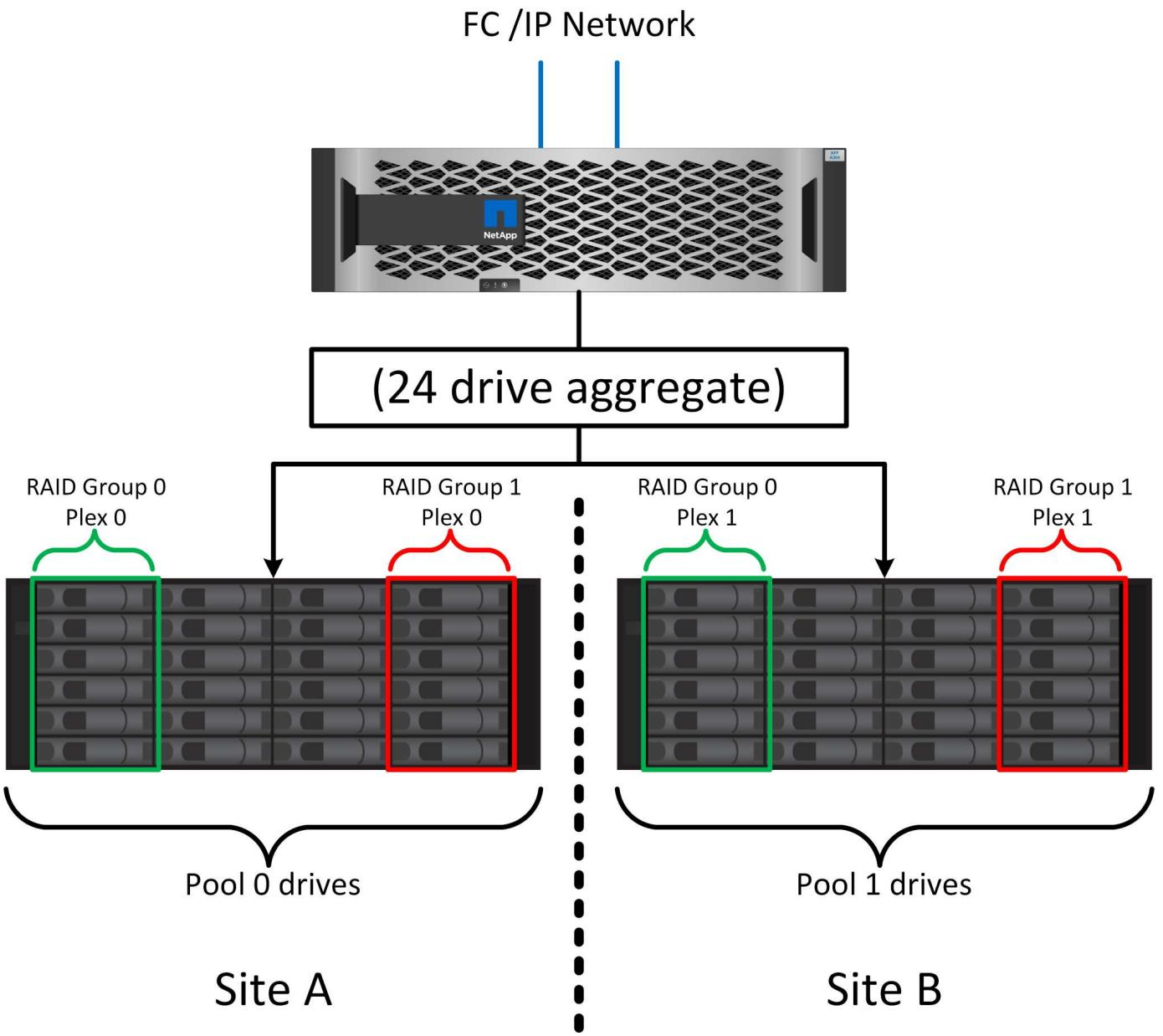
위 그림은 SyncMirror 구성의 예를 보여 줍니다. 24-드라이브 애그리게이트가 사이트 A에 할당된 쉘프의 드라이브 12개와 사이트 B에 할당된 쉘프의 드라이브 12개로 컨트롤러에서 생성되었습니다. 드라이브는 두 개의 미러링된 RAID 그룹으로 그룹화되었습니다. RAID Group 0에는 사이트 B의 6개 드라이브 플렉스에 미러링된 사이트 A의 6개 드라이브 플렉스가 포함되어 있습니다. 마찬가지로, RAID 그룹 1에는 사이트 B의 6개 드라이브 플렉스에 미러링되는 사이트 A의 6개 드라이브 플렉스가 포함되어 있습니다.
