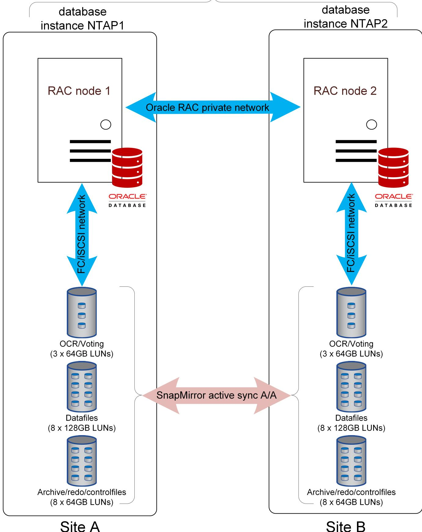
기본 단점은 "비균일 액세스" 사이트 간ONTAP 연결이 끊어지거나 스토리지 시스템이 손실되면 한 사이트에서 데이터베이스 인스턴스가 손실된다는 것입니다. 이는 바람직한 방법은 아니지만 좀 더 단순한 SAN 구성을 위한 대가로 허용 가능한 위험일 수 있습니다.
