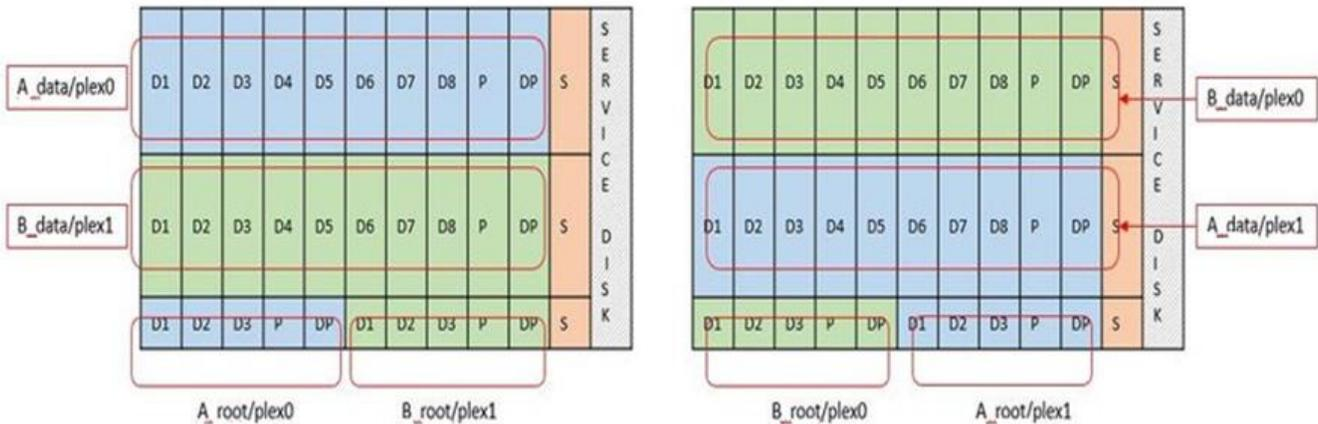
ONTAP 소프트웨어 RAID는 RAID 4, RAID-DP 및 RAID-TEC와 같은 RAID 유형을 지원합니다. 이는 FAS 및 AFF 플랫폼에서 사용되는 RAID 구분과 동일합니다. 루트 프로비저닝의 경우 ONTAP Select는 RAID 4 및 RAID-DP만 지원합니다. 데이터 애그리게이트에 RAID-TEC를 사용할 때는 전반적인 보호 기능이 RAID-DP입니다. ONTAP Select HA는 각 노드의 구성을 다른 노드로 복제하는 무공유 아키텍처를 사용합니다. 즉, 각 노드는 루트 파티션과 해당 피어의 루트 파티션 복제본을 저장해야 합니다. 데이터 디스크에는 단일 루트 파티션이 있으므로 최소 데이터 디스크 수는 ONTAP Select 노드가 HA 쌍의 일부인지 여부에 따라 달라집니다.
