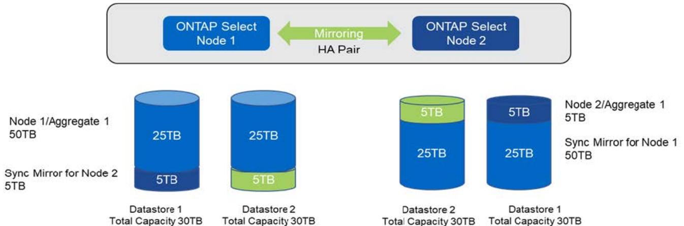
용량 추가 작업 중에 사용되는 최대 VMDK 크기는 16TB입니다. 클러스터 생성 작업 중에 사용되는 최대 VMDK 크기는 8TB입니다. ONTAP 구축 시 구성(단일 노드 또는 다중 노드 클러스터)과 추가 용량에 따라 크기가 올바르게 조정된 VMDK를 생성합니다. 그러나 클러스터 생성 작업 중에는 각 VMDK의 최대 크기가 8TB를 초과하지 않고, 스토리지 추가 작업 중에는 16TB를 초과하지 않아야 합니다.
