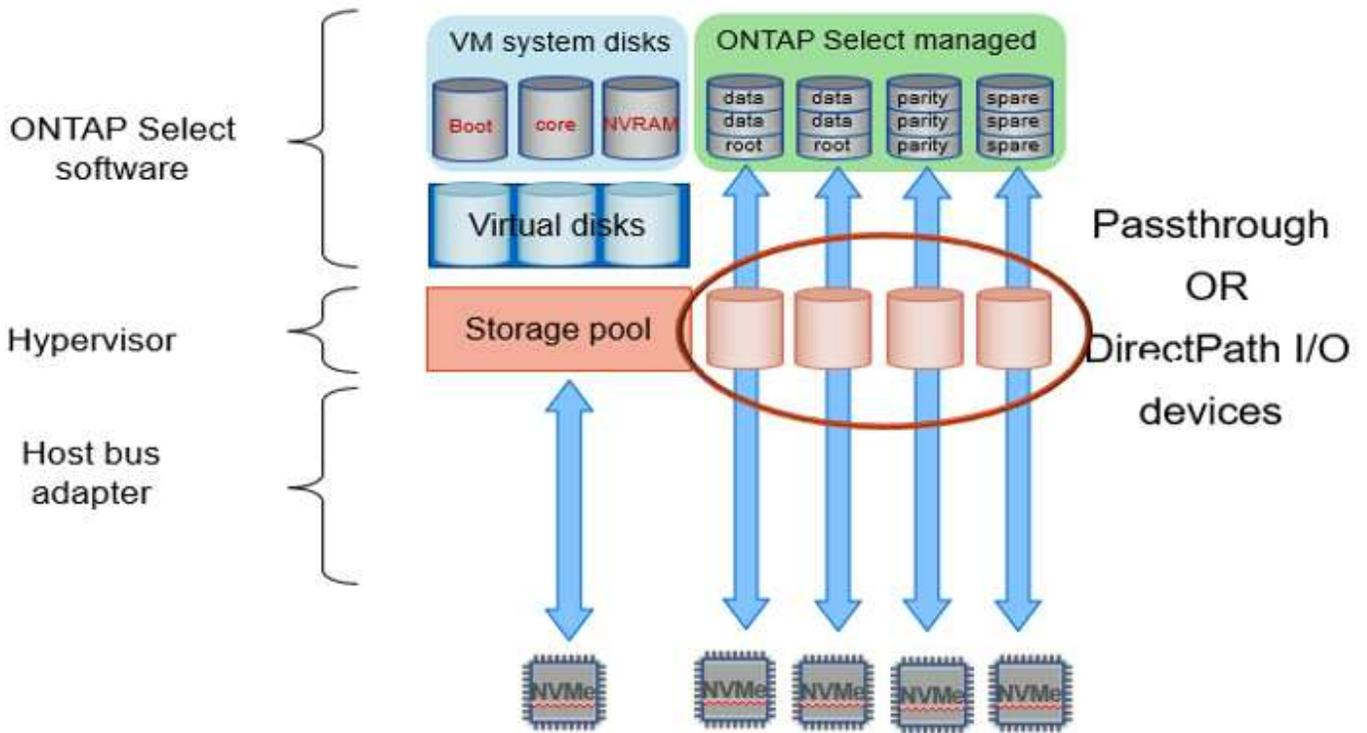
시스템 디스크(VMDK)는 동일한 데이터 저장소와 동일한 물리적 디스크에 상주합니다. 가상 NVRAM 디스크에는 빠르고 내구성이 있는 미디어가 필요합니다. 따라서 NVMe 및 SSD 유형 데이터 저장소만 지원됩니다. NVMe 드라이브를 데이터에 사용할 때 성능 상의 이유로 시스템 디스크도 NVMe 장치여야 합니다. All NVMe 구성에서 시스템 디스크를 사용할 수 있는 적합한 후보는 Intel Optane 카드입니다.
