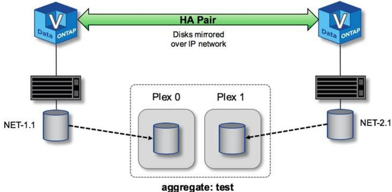
ONTAP Select 클러스터가 구축되면 시스템에 있는 모든 가상 디스크가 올바른 플렉스(plex)에 자동으로 할당되므로 디스크 할당과 관련하여 사용자에게 추가 단계가 필요하지 않습니다. 이렇게 하면 실수로 디스크를 잘못된 플렉스에 할당하지 않고 최적의 미러 디스크 구성을 제공할 수 있습니다.
