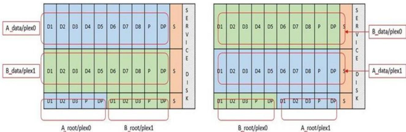
ONTAP 소프트웨어 RAID는 RAID 4, RAID-DP 및 RAID-TEC와 같은 RAID 유형을 지원합니다. 이는 FAS 및 AFF 플랫폼에서 사용되는 RAID 구문과 동일합니다. 루트 프로비저닝의 경우 ONTAP Select는 RAID 4 및 RAID-DP만 지원합니다. 데이터 애그리게이트에 RAID-TEC를 사용할 때는 전반적인 보호 기능이 RAID-DP입니다. ONTAP Select HA는 각 노드의 구성은 다른 노드로 복제하는 무공유 아키텍처를 사용합니다. 즉, 각 노드는 루트 파티션과 해당 피어의 루트 파티션 복제본을 저장해야 합니다. 데이터 디스크에는 단일 루트 파티션이 있으므로 최소 데이터 디스크 수는 ONTAP Select 노드가 HA 쌍의 일부인지 여부에 따라 달라집니다.
