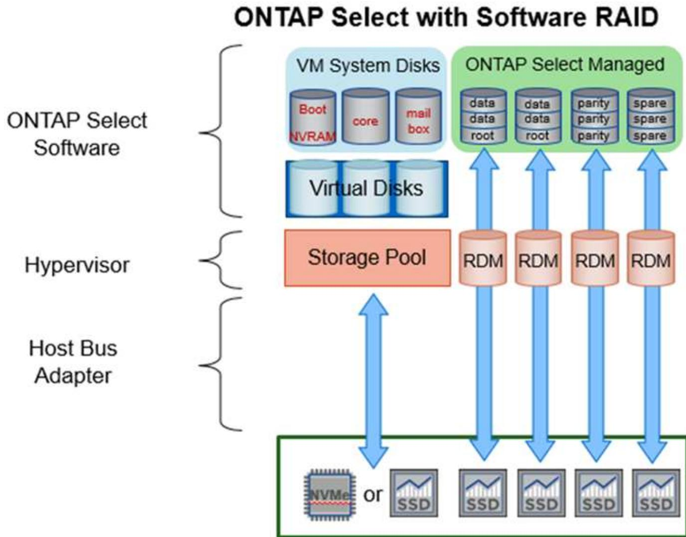
시스템 디스크(VMDK)는 동일한 데이터 저장소와 동일한 물리적 디스크에 상주합니다. 가상 NVRAM 디스크에는
