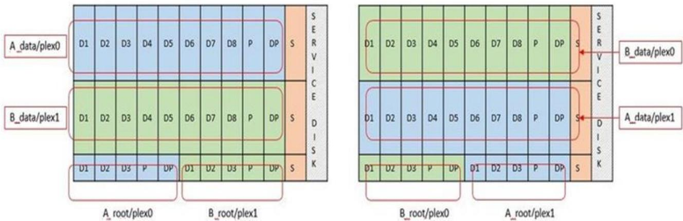
ONTAP 소프트웨어 RAID는 RAID 4, RAID-DP, RAID-TEC 와 같은 RAID 유형을 지원합니다. 이는 FAS 및 AFF 플랫폼에서 사용하는 것과 동일한 RAID 구성입니다. 루트 프로비저닝의 경우 ONTAP Select RAID 4와 RAID-DP만 지원합니다. 데이터 집계에 RAID-TEC 사용하는 경우 전체 보호는 RAID-DP로 설정됩니다. ONTAP Select HA는 각 노드의 구성을 다른 노드에 복제하는 비공유 아키텍처를 사용합니다. 즉, 각 노드는 루트 파티션과 피어의 루트 파티션 복사본을 저장해야 합니다. 데이터 디스크에는 단일 루트 파티션이 있습니다. 즉, ONTAP Select 노드가 HA 쌍에 속하는지 여부에 따라 최소 데이터 디스크 수가 달라집니다.
