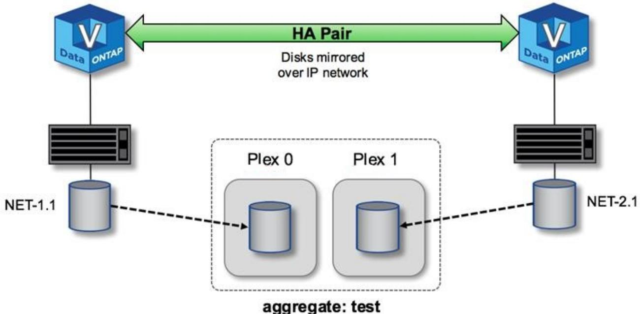
ONTAP Select 클러스터가 구축되면 시스템에 있는 모든 가상 디스크가 올바른 플렉스(plex)에 자동으로 할당되므로 디스크 할당과 관련하여 사용자에게 추가 단계가 필요하지 않습니다. 이렇게 하면 실수로 디스크를 잘못된 플렉스에 할당하지 않고 최적의 미러 디스크 구성성을 제공할 수 있습니다.
