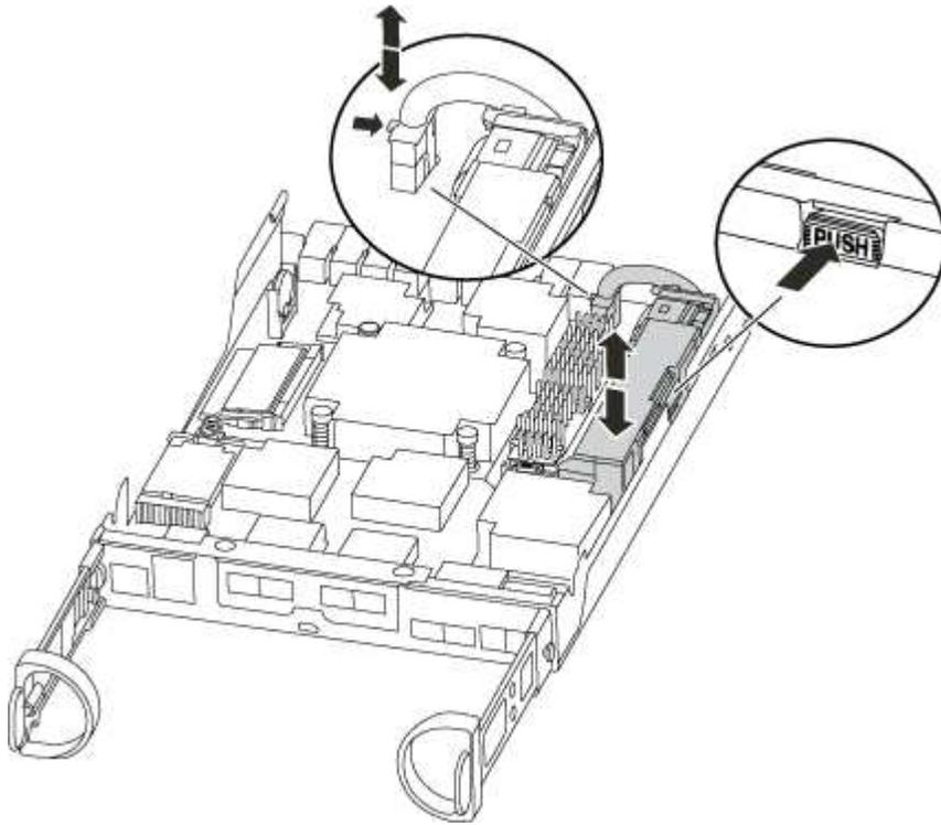
4. 배터리 플러그를 찾아 배터리 플러그 표면에 있는 클립을 눌러 소켓에서 플러그를 분리한 다음 소켓에서 배터리 케이블을 분리합니다.
