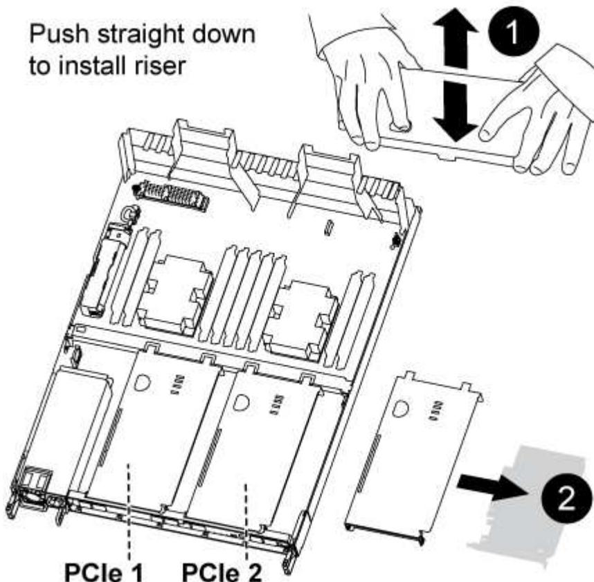
1. 덮개의 파란색 손잡이 나사를 풀어 PCIe 라이저 위에 있는 덮개를 분리하고 덮개를 사용자 쪽으로 밀고 덮개를 위로 돌린 다음 컨트롤러 모듈에서 들어올려 분리합니다.
