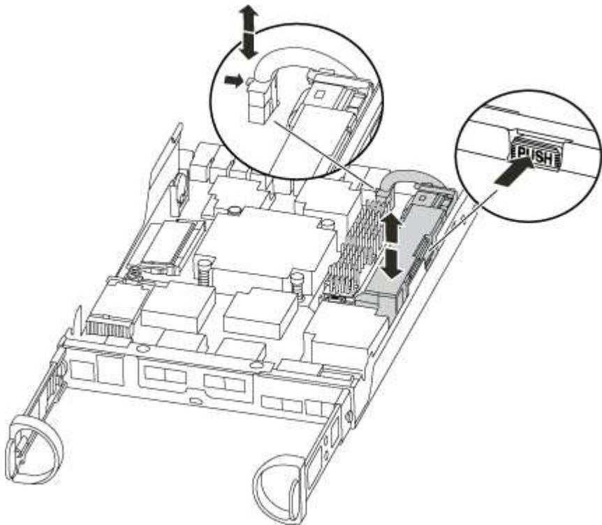
3. 배터리 플러그를 찾아 배터리 플러그 표면에 있는 클립을 눌러 소켓에서 플러그를 분리한 다음 소켓에서 배터리 케이블을 분리합니다.
