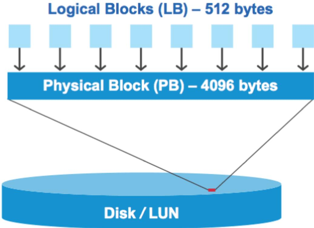
호스트 운영 체제는 모든 논리 블록에서 읽기 또는 쓰기 I/O 작업을 시작할 수 있습니다. I/O 작업은 물리적 블록의 첫 번째 논리적 블록에서 시작될 때만 정렬되는 것으로 간주됩니다. 물리적 블록의 시작이 아닌 논리적 블록에서 I/O 작업이 시작되면 I/O가 잘못 정렬된 것으로 간주됩니다. ONTAP는 자동으로 정렬 불량을 감지하여 LUN에 보고합니다. 하지만 잘못 정렬된 I/O가 있다고 해서 LUN도 제대로 정렬되지 않은 것은 아닙니다. 잘못 정렬된 I/O가 제대로 정렬된 LUN에 보고될 수 있습니다.
