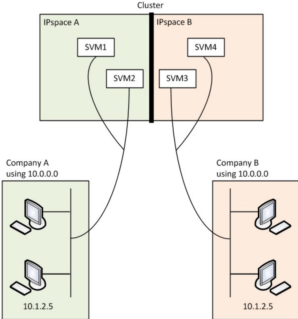
또한, '/etc/hosts' 파일, '/etc/hosts.equiv' 파일 및 '/etc/rc' 파일과 같은 다양한 구성 파일에서 참조하는 IP 주소는 해당 IPspace와 관련이 있습니다. 따라서 IPspace를 사용하면 SSP에서 여러 SVM에 대한 구성 및 인증 데이터에 대해 충돌 없이 동일한 IP 주소를 구성할 수 있습니다.
