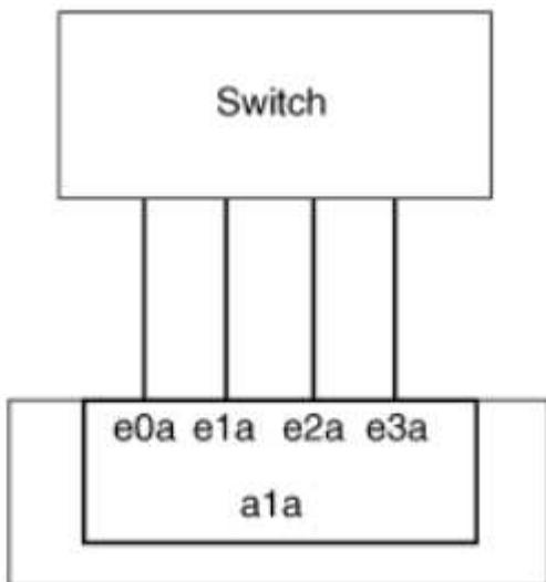
단일 통합 링크의 트래픽을 여러 물리적 스위치에 분산하는 여러 기술이 존재합니다. 이 기능을 지원하는 데 사용되는 기술은 네트워킹 제품에 따라 다릅니다. ONTAP의 정적 멀티모드 인터페이스 그룹은 IEEE 802.3 표준을 준수합니다. 특정 다중 스위치 링크 통합 기술이 IEEE 802.3 표준과 상호 운용되거나 이를 준수한다고 말한다면 ONTAP와 함께 작동해야 합니다.
