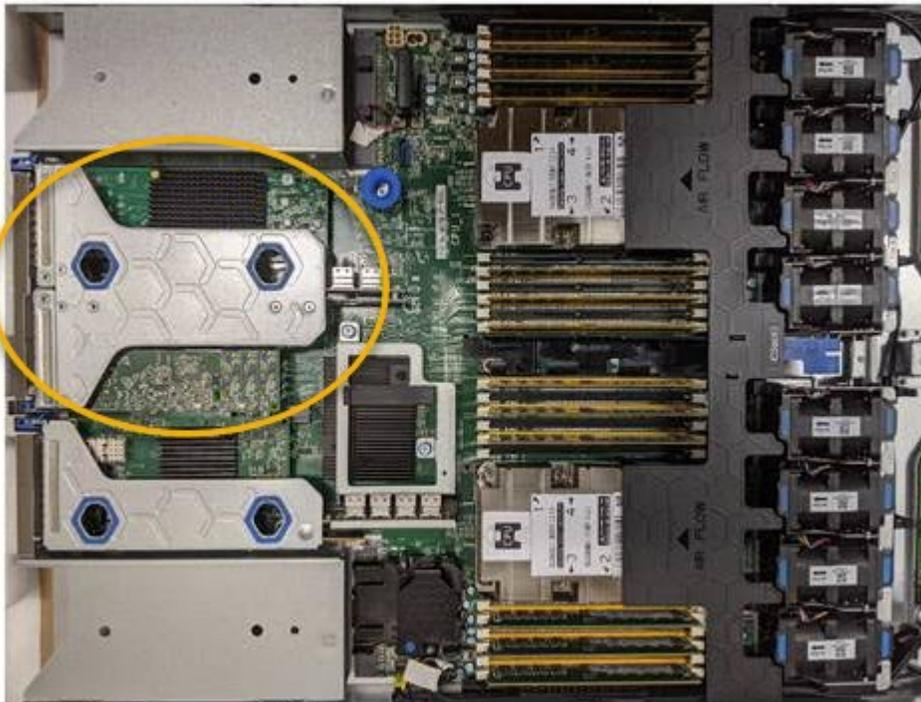
3. 파란색 표시가 있는 구멍을 통해 라이저 조립품을 잡고 조심스럽게 위로 들어 올립니다. 라이저 조립품을 들어 올릴 때 새시 앞쪽으로 이동하여 설치된 어댑터의 외부 커넥터가 새시에서 분리되도록 합니다.
