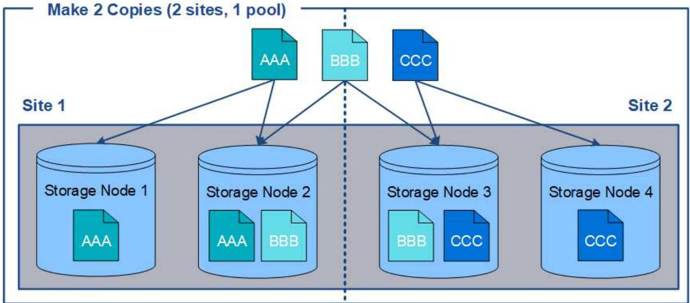
반면, 이 예제에서는 여러 스토리지 풀을 사용할 때 객체가 저장되는 방식을 보여 줍니다. 이 예제에서 ILM 규칙은 각 객체의 복제된 복사본 2개를 생성하고 해당 복사본을 두 스토리지 풀에 분산하도록 지정합니다. 각 스토리지 풀에는 한 사이트의 모든 스토리지 노드가 포함됩니다. 각 객체의 복사본은 각 사이트에 저장되므로 사이트 장애나 액세스 불가능성 으로부터 객체 데이터가 보호됩니다.
