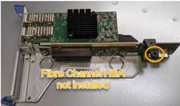
5. 라이저 조립품을 새시에 놓고 시스템 보드의 커넥터 및 가이드 핀에 맞춥니다. 그런 다음 라이저 조립품을 삽입합니다.
