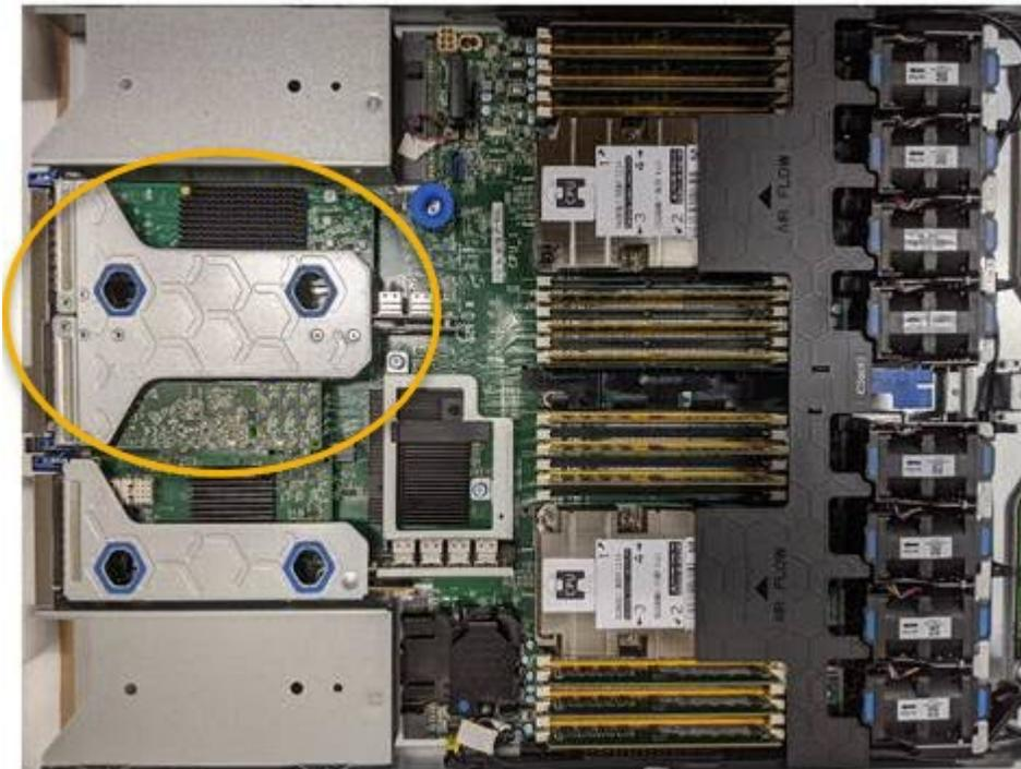
3. 파란색 표시가 있는 구멍을 통해 라이저 조립품을 잡고 조심스럽게 위로 들어 올립니다. 라이저 조립품을 들어 올릴 때 새시 앞으로 이동하여 설치된 어댑터의 외부 커넥터가 새시에서 분리되도록 합니다.
