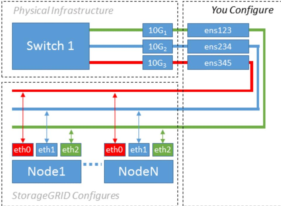
Linux 운영 체제는 설치 또는 부팅 중에 또는 인터페이스가 핫 애드 상태일 때 자동으로 ensXYZ 인터페이스를 생성합니다. 부팅 후 인터페이스가 자동으로 실행되도록 설정하는 것 외에는 구성이 필요하지 않습니다. 나중에 구성 프로세스에서 올바른 매핑을 제공할 수 있도록 StorageGRID 네트워크(그리드, 관리자 또는 클라이언트)에 해당하는 ensXYZ를 결정해야 합니다.
