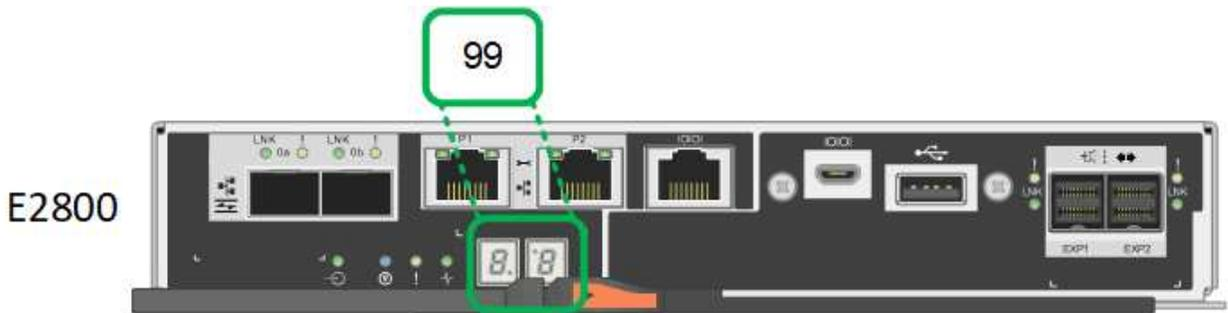
3. 한 컨트롤러 또는 두 컨트롤러 모두에 다른 값이 표시되는 경우 를 참조하십시오 "[하드웨어 설치 문제 해결\(SG6000 또는 SG5700\)](#)" 설치 단계를 올바르게 완료했는지 확인합니다. 문제를 해결할 수 없는 경우 기술 지원 부서에 문의하십시오.
