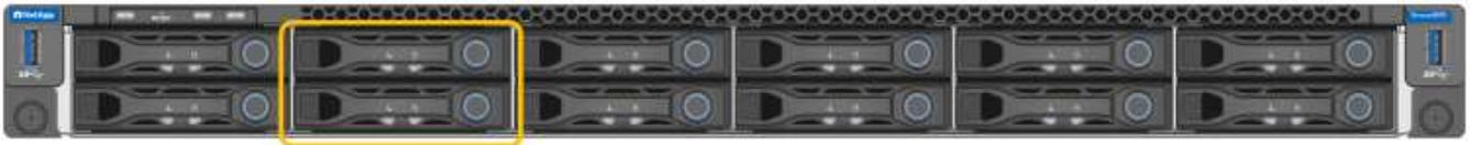
주황색 윤곽선으로 표시된 2개의 SSD(Solid State Drive)는 StorageGRID 운영 체제를 저장하는 데 사용되며 이중화를 위해 RAID 1을 사용하여 미러링됩니다. SG100 또는 SG1000 서비스 어플라이언스가 관리 노드로 구성된 경우 이러한 드라이브는 감사 로그, 메트릭 및 데이터베이스 테이블을 저장하는 데 사용됩니다.
