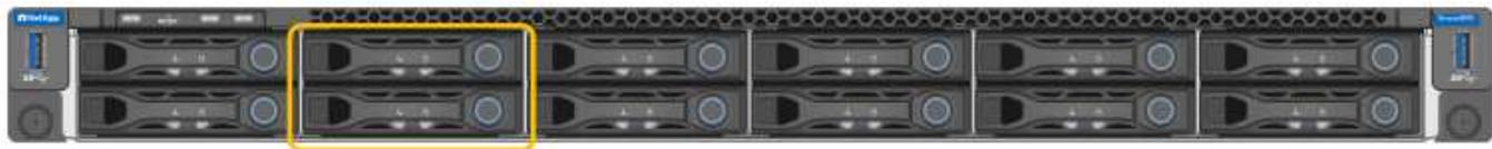
주황색 윈도우로 표시된 2개의 SSD(Solid State Drive)는 StorageGRID 운영 체제를 저장하는 데 사용되며 이중화를 위해 RAID 1을 사용하여 미러링됩니다. SG100 또는 SG1000 서비스 어플라이언스가 관리 노드로 구성된 경우 이러한 드라이브는 감사 로그, 메트릭 및 데이터베이스 테이블을 저장하는 데 사용됩니다.
