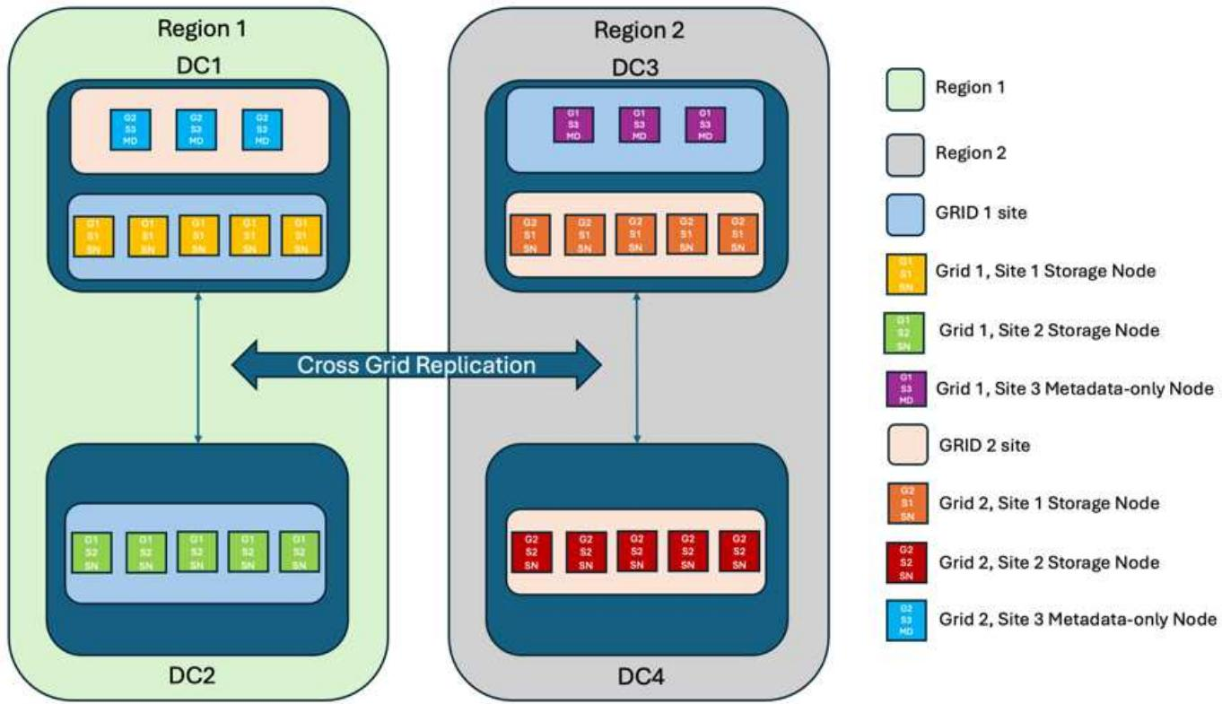
이 솔루션은 4개의 별도 위치를 통해 RPO를 0으로 유지하는 2개의 개별 StorageGRID 시스템을 완벽하게 이중화하고 멀티 사이트 동기식 복제와 멀티 그리드 비동기식 복제를 모두 활용합니다. 두 StorageGRID 시스템에서 아무런 중단 없는 클라이언트 작업을 유지하면서 단일 사이트에 장애가 발생할 수 있습니다.
