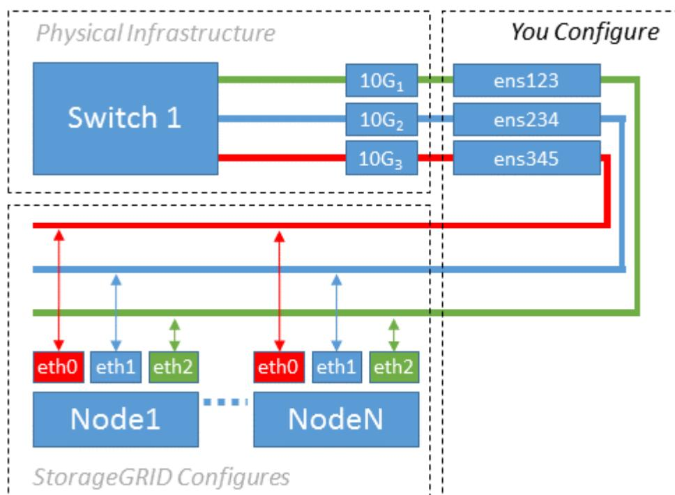
Linux 운영 체제는 다음을 생성합니다. ensXYZ 설치 또는 부팅 중에 인터페이스가 자동으로 추가되거나 인터페이스가 핫 애드될 때 인터페이스가 자동으로 추가됩니다. 부팅 후 인터페이스가 자동으로 실행되도록 설정하는 것 외에는 다른 구성이 필요하지 않습니다. 나중에 구성 프로세스에서 올바른 매팅을 제공할 수 있도록 어떤 ensXYZ가 어떤 StorageGRID 네트워크(Grid, Admin 또는 Client)에 해당하는지 확인해야 합니다.
