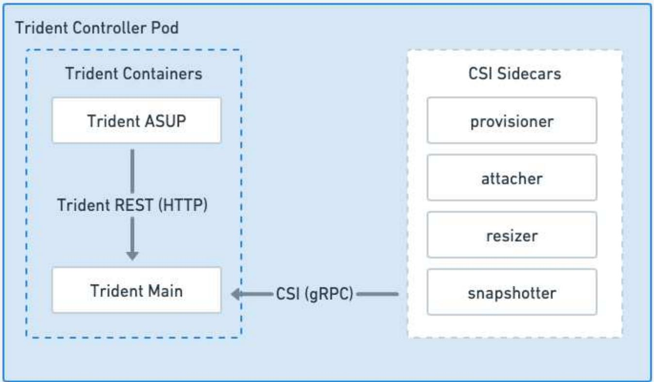
그림 2. Trident 컨트롤러 Pod 다이어그램
