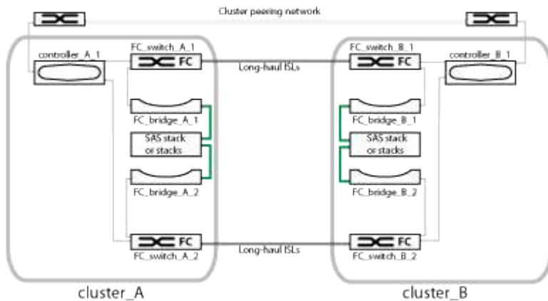
Uma configuração de dois nós consiste em dois clusters, um em cada local geograficamente separado. O cluster\_A está localizado no primeiro site do MetroCluster. O cluster\_B está localizado no segundo site do MetroCluster. Cada local tem uma pilha de storage SAS. São suportadas stacks de armazenamento adicionais, mas apenas uma é mostrada em cada local.
