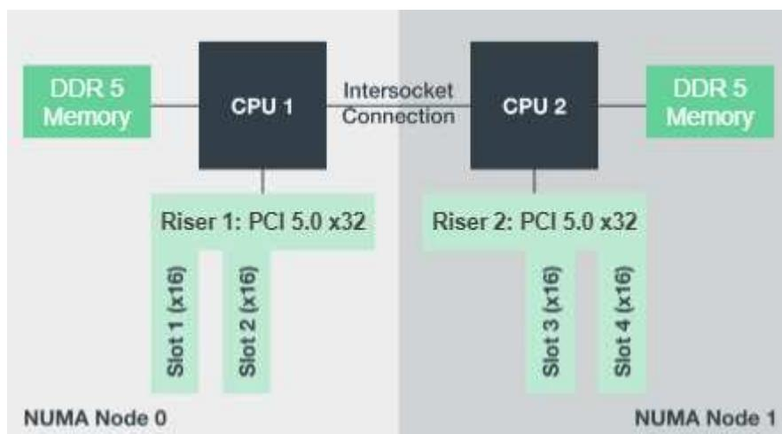
Os processos BeeGFS são fixados a uma zona NUMA específica para garantir que as interfaces usadas estejam na mesma zona. Esta configuração evita a necessidade de acesso remoto através da ligação entre sockets. A conexão entre soquetes às vezes é conhecida como QPI ou link GMI2; mesmo em arquiteturas de processador modernas, eles podem ser um gargalo ao usar redes de alta velocidade como HDR InfiniBand.
