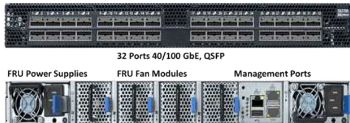
Figura 4. SN2700 interruptor dianteiro e traseiro
