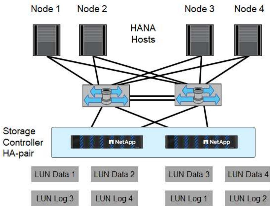
Além do zoneamento na camada do switch, você deve mapear cada LUN no sistema de armazenamento para os hosts que se conectam a esse LUN. Mantenha o zoneamento no switch simples, ou seja, defina um conjunto de zona em que todos os HBAs host podem ver todos os HBAs do controlador.
