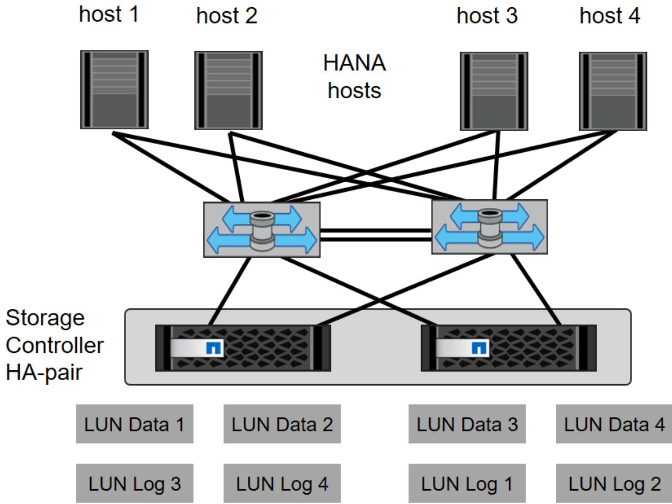
Além do zoneamento na camada do switch, você deve mapear cada LUN no sistema de armazenamento para os hosts que se conectam a esse LUN. Mantenha o zoneamento no switch simples, ou seja, defina um conjunto de zona em que todos os HBAs host podem ver todos os HBAs do controlador.
