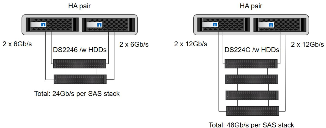
Com os SSDs, é possível conectar um máximo de um compartimento de disco a uma stack de SAS para fornecer a performance necessária para os hosts SAP HANA, como mostrado na figura a seguir. Os discos em cada gaveta devem ser distribuídos igualmente para as duas controladoras do par de HA. Com o compartimento de disco DS224C, o cabeamento SAS de quatro caminhos também pode ser usado, mas não é necessário.
