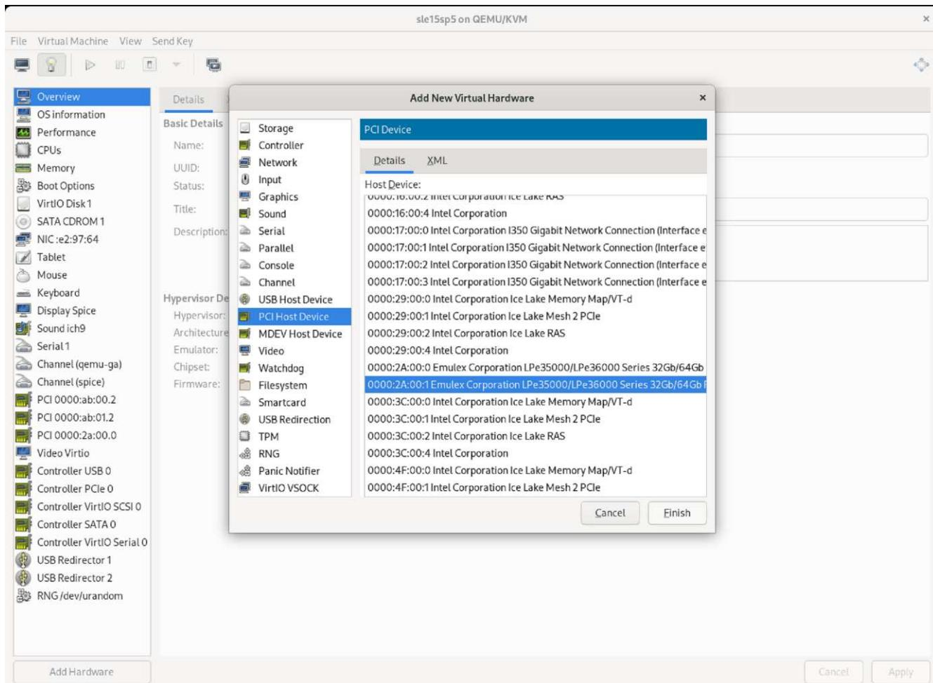
6. Em seguida, as portas HBA físicas são atribuídas à máquina virtual e a máquina virtual pode ser iniciada.
