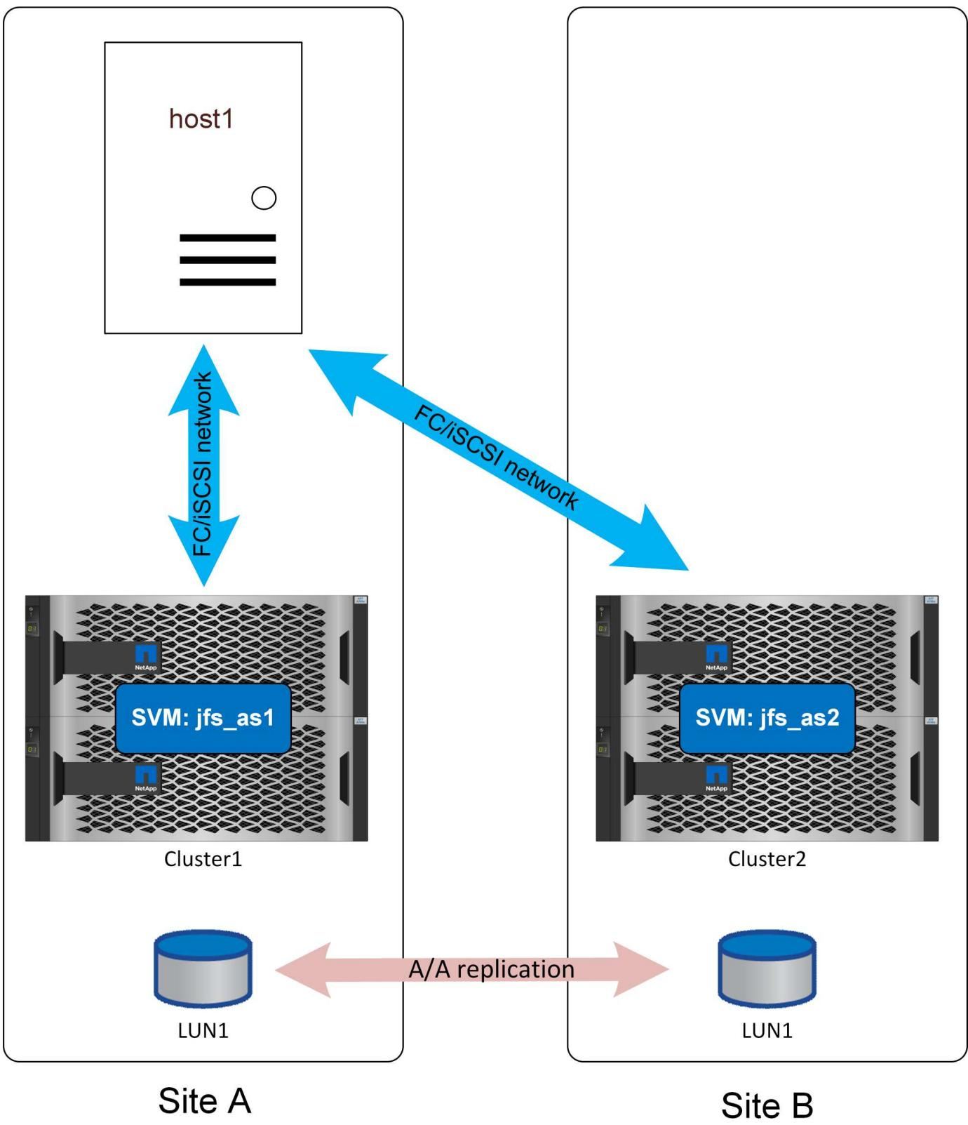
Com acesso uniforme, uma falha de armazenamento em qualquer um dos locais não interromperia as operações do banco de dados. Uma falha completa do local no site que incluía o servidor do banco de dados resultaria, naturalmente, em uma falha.
