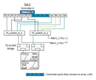
Na ilustração a seguir mostrando a conetividade entre sistemas ONTAP e LUNs de array, as portas HBA 0a a 0d são usadas para conetividade com LUNs de storage porque as portas 1a a 1D são usadas para conetividade com discos:
