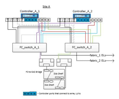
Na ilustração a seguir, que mostra a conetividade entre sistemas ONTAP e LUNs de storage, as portas HBA 0a a 0d são usadas para conetividade com LUNs de storage porque as portas 1a a 1D são usadas para conetividade com discos:
