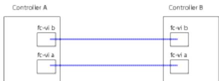
A ilustração acima é uma representação típica do cabeamento necessário. As portas FC-VI específicas variam de acordo com o módulo do controlador.
