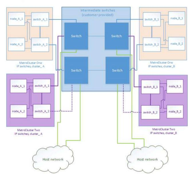
Combinação de uma configuração MetroCluster usando switches validados pela NetApp e uma configuração usando switches compatíveis com MetroCluster
