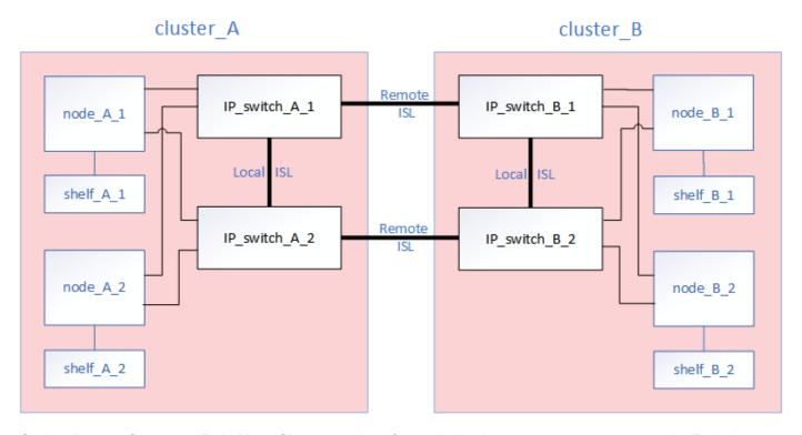
Cada nó na configuração IP do MetroCluster tem interfaces dedicadas para conexão com a rede IP de backend:
