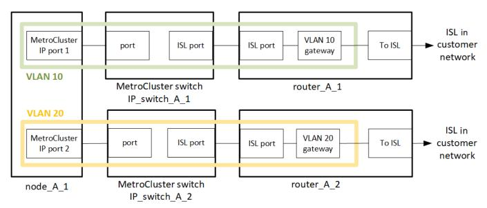
O ambiente MetroCluster é configurado e cabeado como uma configuração IP MetroCluster padrão, conforme descrito em "Configure os componentes de hardware do MetroCluster". Ao executar o procedimento de instalação e cabeamento, você deve executar as etapas específicas de uma configuração de camada 3. O seguinte se aplica às configurações da camada 3:
