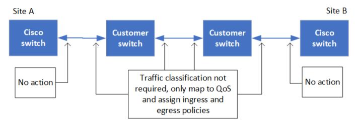
O diagrama a seguir apresenta uma visão geral das configurações necessárias para uma rede compartilhada quando os switches externos são switches IP Broadcom.
