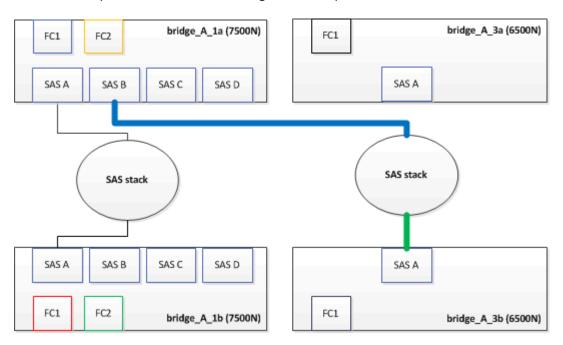
4. Usando um cabo com um conetor mini-SAS, conete a mesma porta SAS no compartimento de armazenamento à porta SAS B da ponte FibreBridge 7600N ou 7500N inferior.
