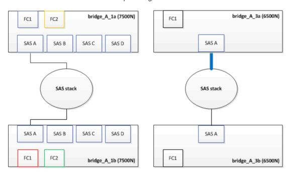
2. Usando um cabo com um conetor mini-SAS, conete a mesma porta SAS no compartimento de armazenamento à porta SAS B da ponte FibreBridge 7600N ou 7500N superior.
