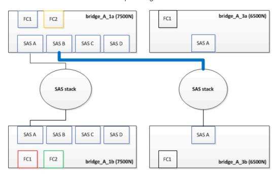
3. Remova o cabo que coneta a porta SAS A da ponte FibreBridge 6500N inferior à gaveta SAS superior, certificando-se de anotar a porta SAS na gaveta de armazenamento à qual ela se coneta.
