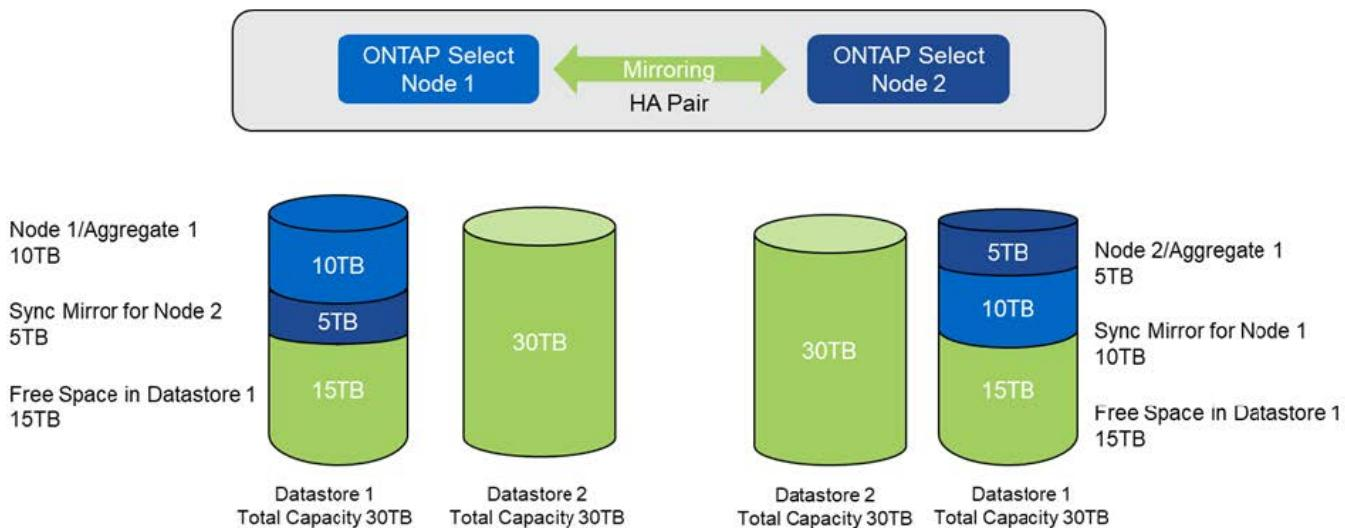
Duas operações adicionais de adição de storage no nó 1 consomem o resto do datastorer 1 e uma parte do datastorer 2 (usando o limite de capacidade). A primeira operação de adição de storage consome 15TB GB de espaço livre no datastorer 1. A figura a seguir mostra o resultado da segunda operação de adição de armazenamento. Nesse ponto, o nó 1 tem 50TB TB de dados ativos sob gerenciamento, enquanto o nó 2 tem 5TB original.
