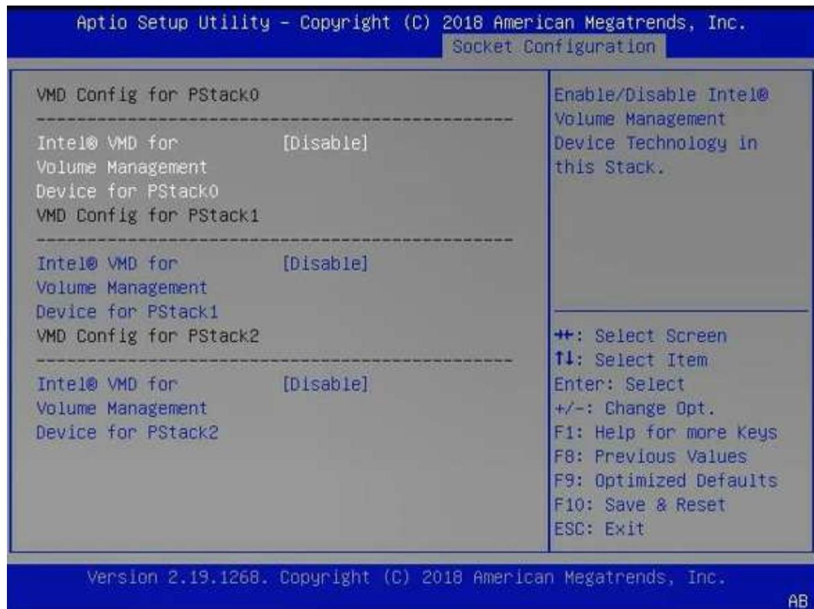
4. Configurar as unidades NVMe para passagem para máquinas virtuais.
