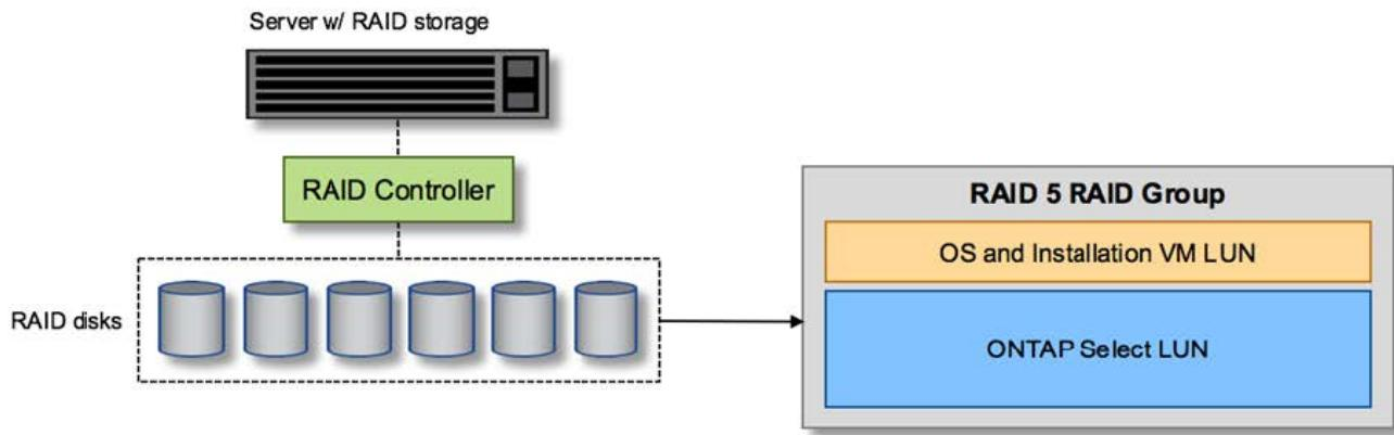
O provisionamento de LUNs do SO a partir do mesmo grupo RAID que o ONTAP Select permite que o sistema operacional do hipervisor (e qualquer VM cliente que também seja provisionada a partir desse armazenamento) se beneficiem da proteção RAID. Essa configuração impede que uma falha de unidade única derrube todo o sistema.
