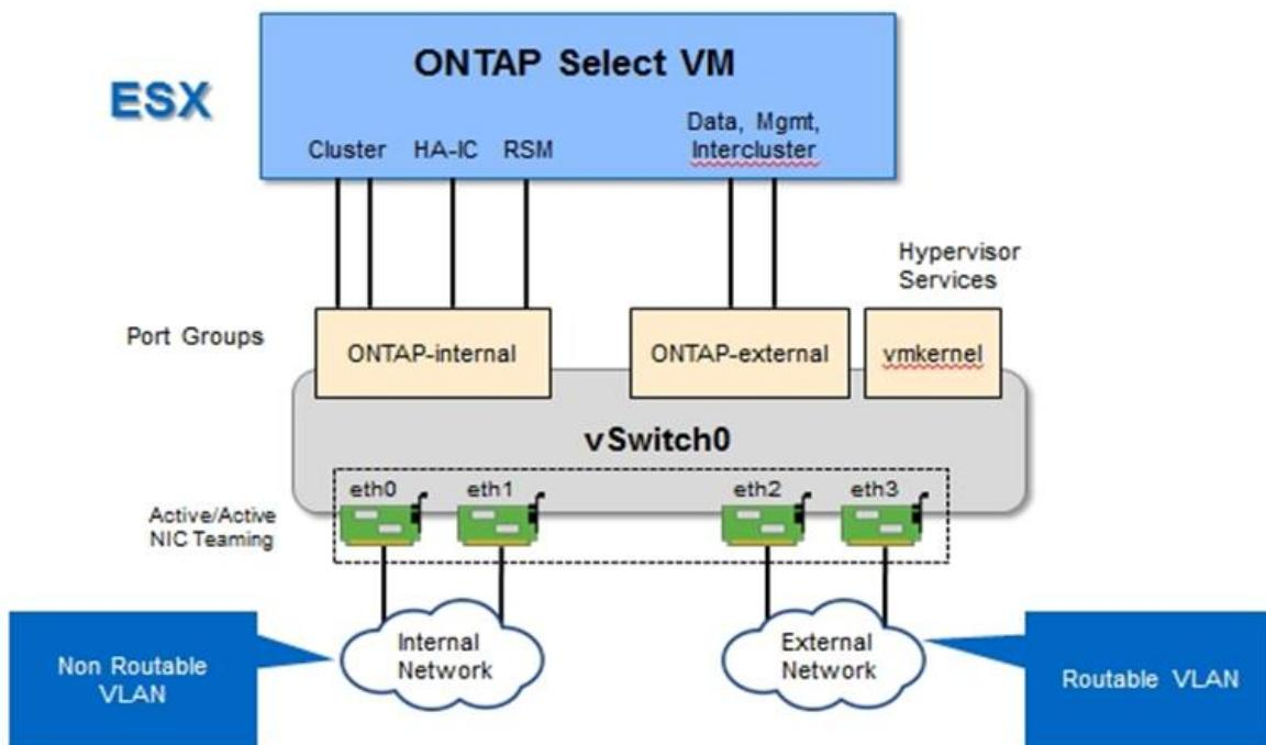
A segregação do tráfego interno e externo em diferentes NICs físicas evita o acesso insuficiente aos recursos de rede, introduzindo latências no sistema. Além disso, a agregação por meio de NIC teaming permite que o nó de cluster ONTAP continue acessando a rede se uma única placa de rede falhar.
