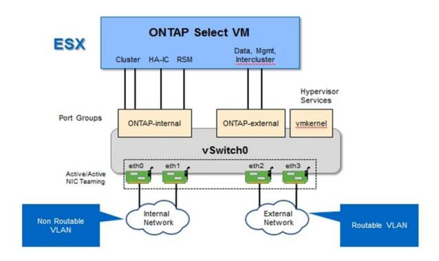
Segregar o tráfego interno e externo entre diferentes NICs físicos impede que latências sejam introduzidas no sistema devido ao acesso insuficiente aos recursos de rede. Além disso, a agregação através do agrupamento NIC garante que a falha de um único adaptador de rede não impede que o nó do cluster ONTAP Select acesse a respetiva rede.
