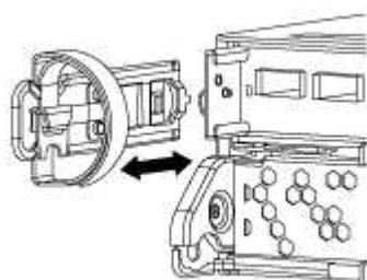
3. Aperte o trinco na pega do excêntrico até que este se solte, abra totalmente o manípulo do excêntrico para libertar o módulo do controlador do plano médio e, em seguida, utilizando duas mãos, puxe o módulo do controlador para fora do chassis.
