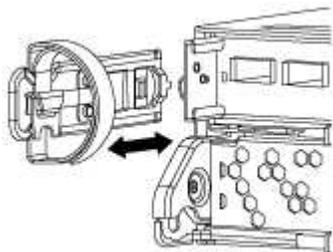
3. Aperte o trinco na pega do excêntrico até que este se solte, abra totalmente o manípulo do excêntrico para libertar o módulo do controlador do plano médio e, em seguida, utilizando duas mãos, puxe o módulo do controlador para fora do chassis.
