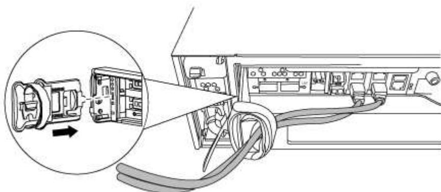
3. Desaperte o parafuso de aperto manual na pega do excêntrico no módulo do controlador.
