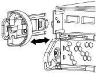
4. Se você deixou os módulos SFP no sistema depois de remover os cabos, mova-os para o novo módulo do controlador.
