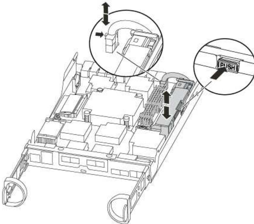
3. Localize a ficha da bateria e aperte o clipe na face da ficha da bateria para soltar a ficha da tomada e, em seguida, desligue o cabo da bateria da tomada.
