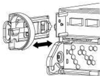
4. Aperte o trinco na pega do excêntrico até que este se solte, abra totalmente o manípulo do excêntrico para libertar o módulo do controlador do plano médio e, em seguida, utilizando duas mãos, puxe o módulo do controlador para fora do chassis.
