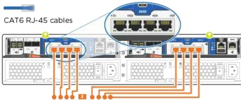
1. Faça o cabeamento das e0M portas aos switches de rede de gerenciamento com os cabos RJ45.
